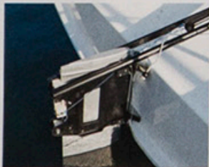
FLEXIBEL Das Ruderblatt ist nur eingesteckt und kann jederzeit aufgeholt werden
