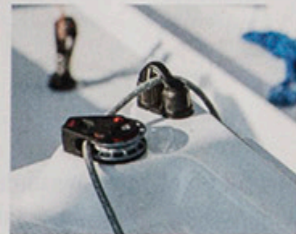
FORDERND Die Fockschot wird einmal übersetzt direkt gefahren. Wünschen gibt es keine
